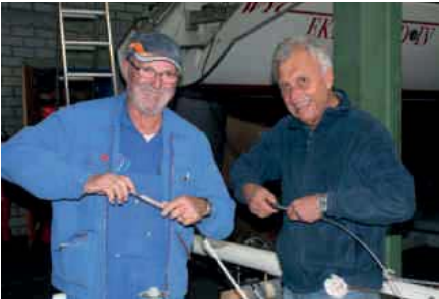
Auch die Terminals müssen gereinigt und geschmiert werden.
