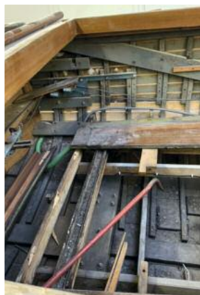
Foto rechts: Die Steueranlage ist noch original erhalten. Foto ganz rechts: Die Zwischenräume der Planken werden mit Lärchenholzstäben gefüllt. Foto unten: Ausgesägte Schadstellen und neu eingesetzte Planken. Fotos: D. Dornier/ Dornier-Museum
