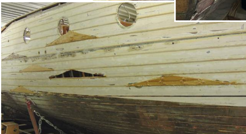
Foto rechts: Die Steueranlage ist noch original erhalten. Foto ganz rechts: Die Zwischenräume der Planken werden mit Lärchenholzstäben gefüllt. Foto unten: Ausgesägte Schadstellen und neu eingesetzte Planken. Fotos: D. Dornier/ Dornier-Museum
