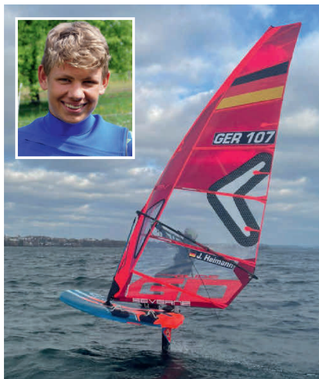
Jonne Heimann Ende Februar vor Seemoos auf dem neuen iQFOiL. Das Surfbrett hat einen „Foil“ bekommen, einen kleinen Tragflügel. Schon bei geringen Geschwindigkeiten kommt damit das Surfbrett aus dem Wasser, fliegt über den See. Surfen in einer neuen Dimension, die dem Sport im wahrsten Sinne des Wortes neuen Auftrieb verleiht. Fotos © Jakob Janich, Heimann Sailing
